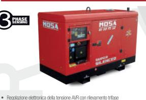
MOTORE - 4-TEMPI, TURBOCOMPRESSO PERKINS 1103A-33TG1 Modello Consumo carburante (75 % di PRP) 8.2 lt./h Capacità serbatoio 100 I sincrono trifase, autoeccitato, autoregolato, **Alternatore** senza spazzole Potenza trifase stand-by 51 kVA (40.8 kW) / 400V / 73.6 A Potenza trifase PRP 46 kVA (36.8 kW) / 400V / 66.4 A Potenza monofase PRP 17 kVA / 230V / 73.9 A Dimensioni Lxlxh (mm) 2050x900x1420 mm Peso a secco 1100 ka Pressione acustica 65 dB(A) @ 7m
