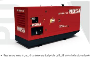
MOTORE - 4-TEMPI, INIEZIONE DIRETTA, TURBOCOMPRESSO Modello FPT NEF67 TM4 Consumo carburante (75 % di PRP) 29.4 lt./h Capacità serbatoio 425 I Alternatore sincrono trifase, autoeccitato, autoregolato, senza spazzole Potenza trifase stand-by 192 kVA (153.6 kW) /400V/ 277 A Potenza trifase PRP 175 kVA (140 kW) / 400V / 252 A Potenza trifase COP 140 kVA (112 kW) / 400V / 202 A Dimensioni Lxlxh (mm) 3750x1400x2020 mm Peso a secco 2800 kg 70 dB(A) @ 7 m Pressione acustica
